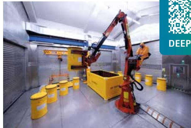
Befüllen eines Containers mittels Fassgreifer.
