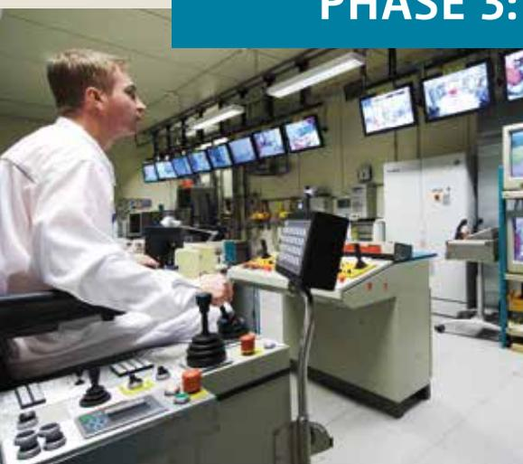
Stark kontaminierte oder auch aktivierte Bereiche werden zunächst fernhantiert zurückgebaut. Der Abbau der technischen Komponenten und die Dekontamination von Wänden, Böden und Decken erfolgt dabei über sogenannte Manipulatoren. Das heißt, dass das Fachpersonal die
