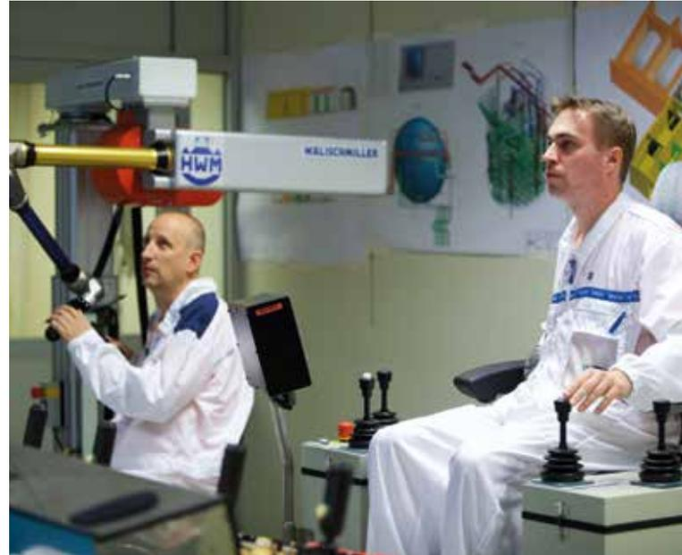
*Bedient werden Bagger und Manipulatorarm aus dem Leitstand heraus – ein Team aus speziell geschulten Fachkräften steuert dort die feinen Bewegungen simultan am Bildschirm.*
